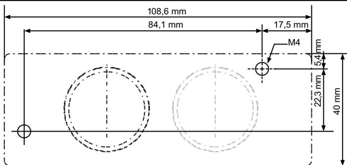
In alternativa al montaggio con barra metallica tramite clip, la parte inferiore della custodia può essere avvitata direttamente. Raccomandazione: viti M4 (diametro del foro di fissaggio: 4,6 mm).
