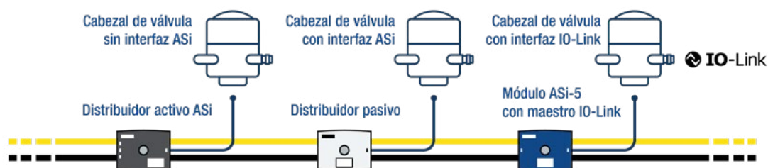
Diferentes opciones de conexión de los cabezales de válvula con ASi
