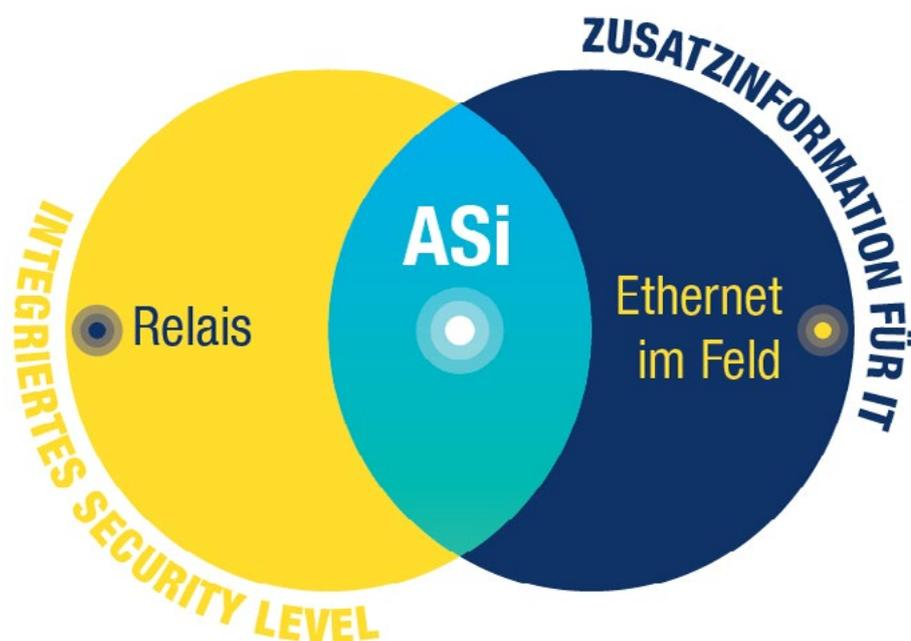
Der kommunikative Bruch zwischen TCP/IP- und Feldebene im Gateway sorgt dafür, dass ASi der IT ein hohes Maß an verfügbaren Zusatzinformationen wie z. B. Diagnosedaten zur Verfügung stellen kann und gleichzeitig bestmöglich vor Cyber-Attacken geschützt ist.
