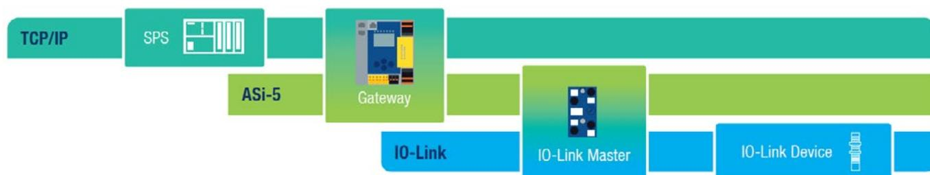
Durch das ASi-5/ASi-3 Feldbus Gateway von Bihl+Wiedemann erfolgt eine physische Entkopplung zwischen TCP/IP und ASi-5 sowie ASi-5 Safety, sprich der Feldbus- und der Feldebene.
