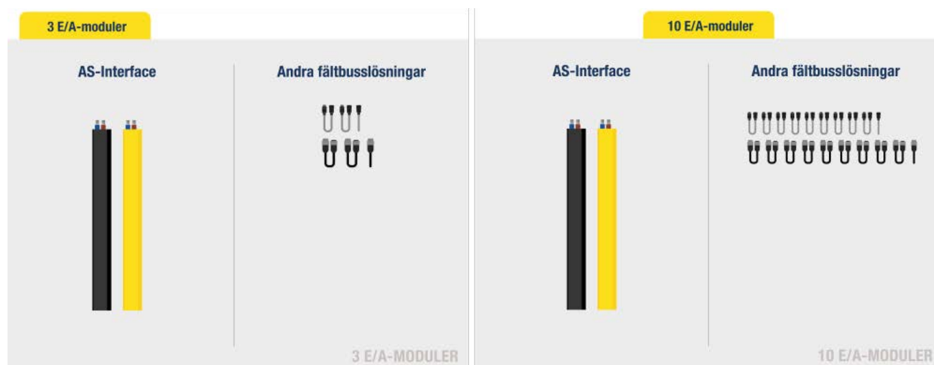
Jämförelse: Resurskrav för olika automationslösningar för integrering av I/O-moduler
