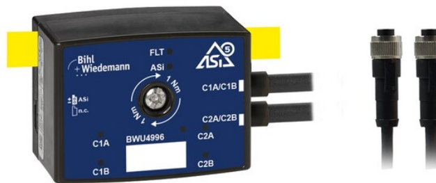
Bild: Hos den nya ASi-5-räknarmodulen ( BWU4996 ) i IP67 försörjs ingångar och sensorer från ASi samt tillbehör via 2x M12-kabeldosor (5-poliga).
