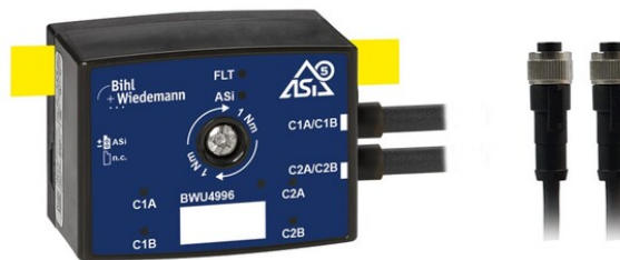
Fig.: En el nuevo módulo de contaje ASi-5 ( BWU4996 ) en IP67, las entradas y sensores están alimentados desde ASi, así como los periféricos se alimentan a través de 2 conectores hembra para cable M12 (de 5 polos).
