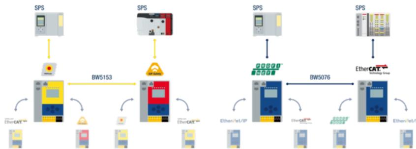
„Sichere Kopplung“ (BW5153, links) und „Feldbus-Kopplung“ (BW5076, rechts) sind eine **einfache Alternative zu Buskopplern oder PN/PN-Kopplern**
