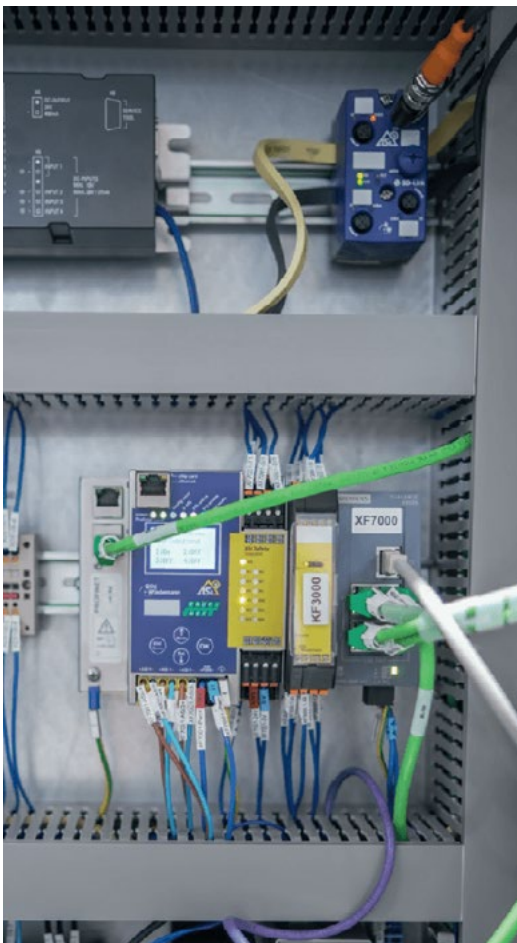
Für die Nutzung von Prozessdaten können IO-Link Sensoren einfach über ASi-5 Module mit integrierten IO-Link Mastern (oben) und ASi-5/ASi-3 Safety Gateways (unten) von Bihl+Wiedemann in bestehende ASi Netzwerke integriert werden.
