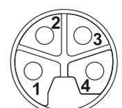
(1) Um den Maximalstrom  $I_{max}$  verwenden zu können, müssen alle 4 Pins kontaktiert sein.
