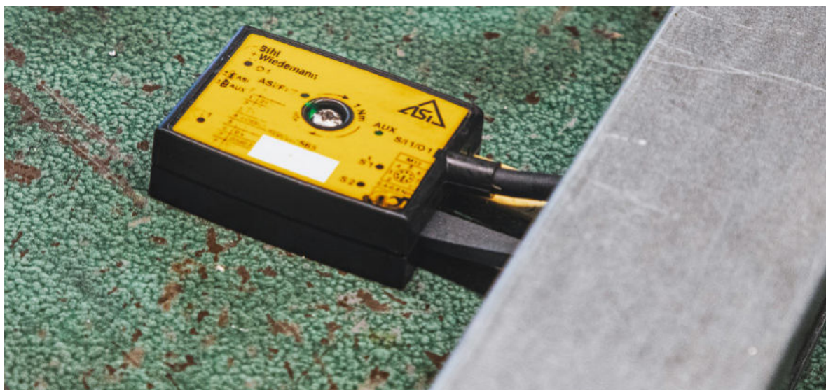
Aktiver Verteiler ASi Safety (BWU3565) in IP67 für die einfache, schnelle und sichere Integration eines Türschalters über das Profilkabel in das ASi Netzwerk.
