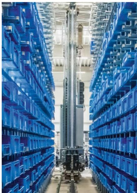
Regalbediengerät mit Stromschiene in Gasse
