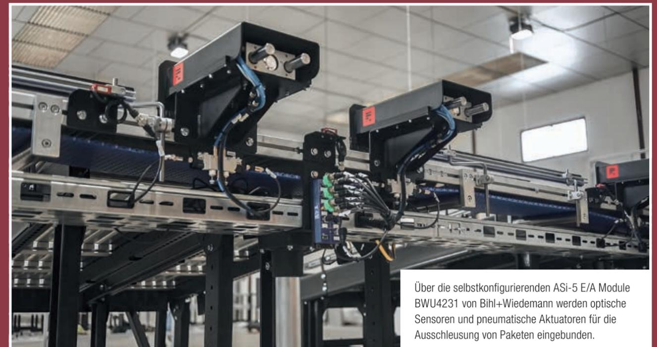
Über die selbstkonfigurierenden ASI-5 E/A Module BWU4231 von Bihl+Wiedemann werden optische Sensoren und pneumatische Aktuatoren für die Ausschleusung von Paketen eingebunden.
