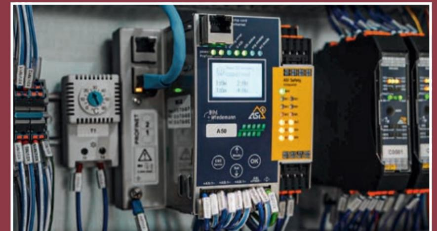
ASI-5/ASI-3 PROFINET Gateway BWU3862 mit integriertem Sicherheitsmonitor (links) und selbstkonfigurierende E/A Module ASI-5 BWU3884 in IP20 (rechts) von Bihl+Wiedemann.
