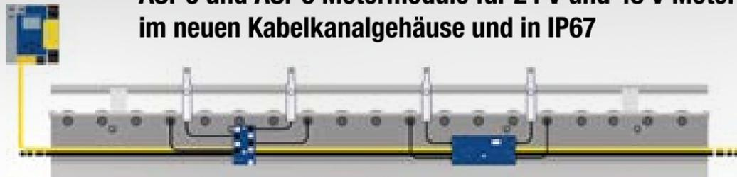
Für die Ansteuerung von 24 V und 48 V Motorrollen über ASi-5 und ASi-3 bietet Bihl+Wiedemann ein umfangreiches Sortiment an Motormodulen. Ergänzend zu den beiden ASi-5 Motormodulen BWU4212 und BWU4246 im IP67-Gehäuse für die Ansteuerung von je zwei 48 V bzw. 24 V Motorrollen des Typs Interroll EC5000 AI und weiterer ASi-3 Module für Rollentriebe weiterer Hersteller wie Itoh Denki, Rollex oder RULMECA hat das Unternehmen eine neue Produktfamilie
