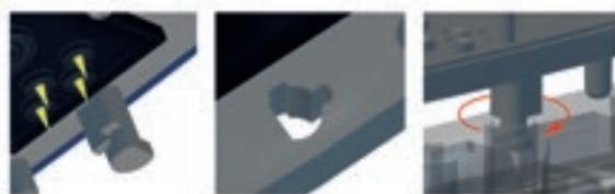
Durch die Verbindung von Oberteil und Unterteil über einen Steckschlüssel-Mechanismus ist das Oberteil für die Montage frei drehbar, ohne dass die Gefahr besteht, das Profilkabel zu beschädigen.
