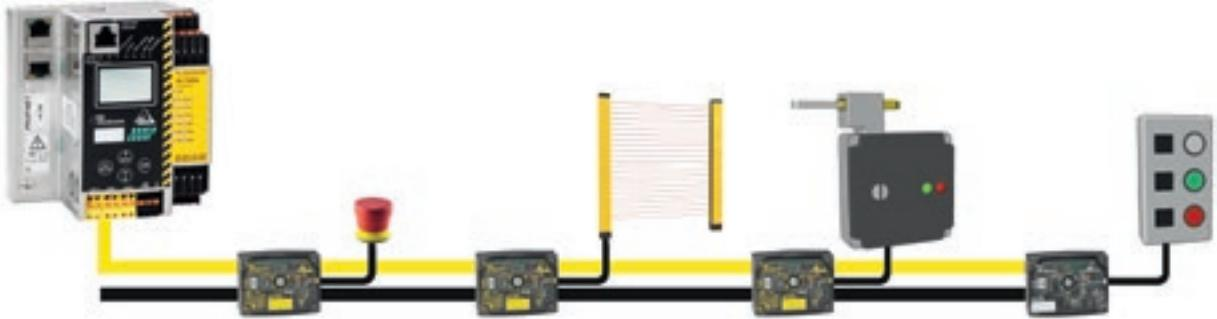
Mit aktiven Verteilern von Bihl+Wiedemann lassen sich die unterschiedlichsten Sensoren, Taster oder Schalter AS-i fähig machen und so ohne großen Aufwand im AS-Interface Netzwerk verwenden.
